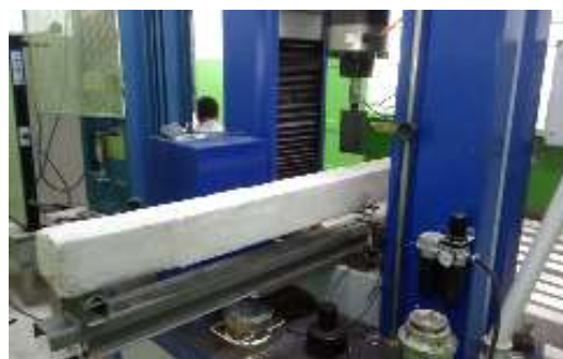
Fig.6: Ensaio de determinação das flechas nas vigotas.
