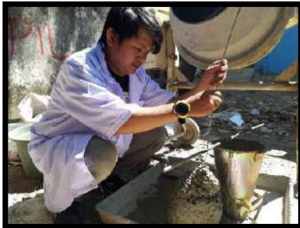
Fig.1. Slump test Apparatus
