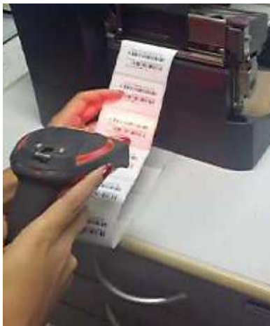
Fig.11 – Teste de leitura dos códigos de barras com a nova proposta
