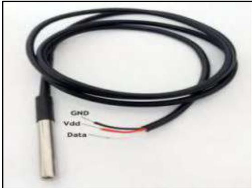
Fig.3: Physical form of DS18B20 & Waterproof Probe
