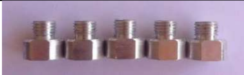
Fig. 2: Aluminum parts 6061-T6
