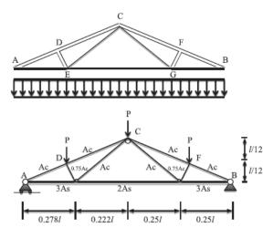
Fig. 12: Vista esquemática da treliça de telhado (KESHTEGAR e MENG [20])
