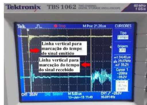
Fig. 3: Tempo de percurso da onda ultrassônica através da barra de aço 1020
