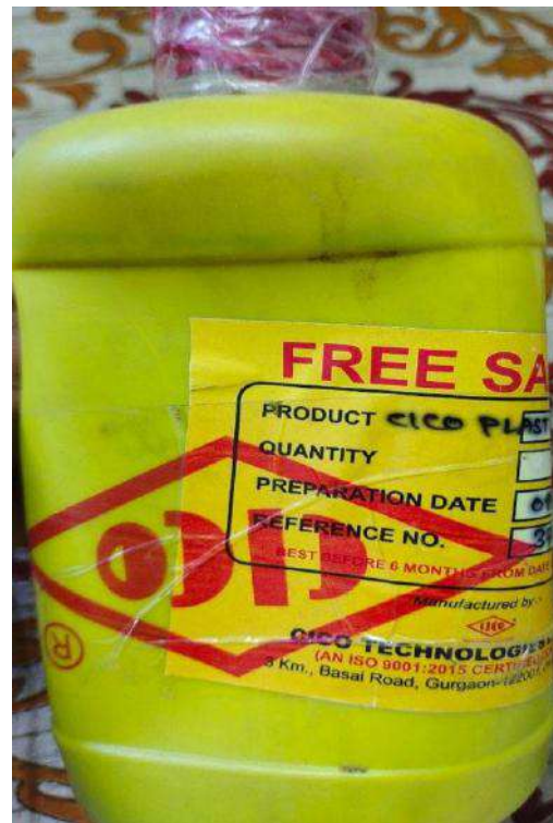
Fig. 1: Super plasticizer (CICO PLAST P190-A)
