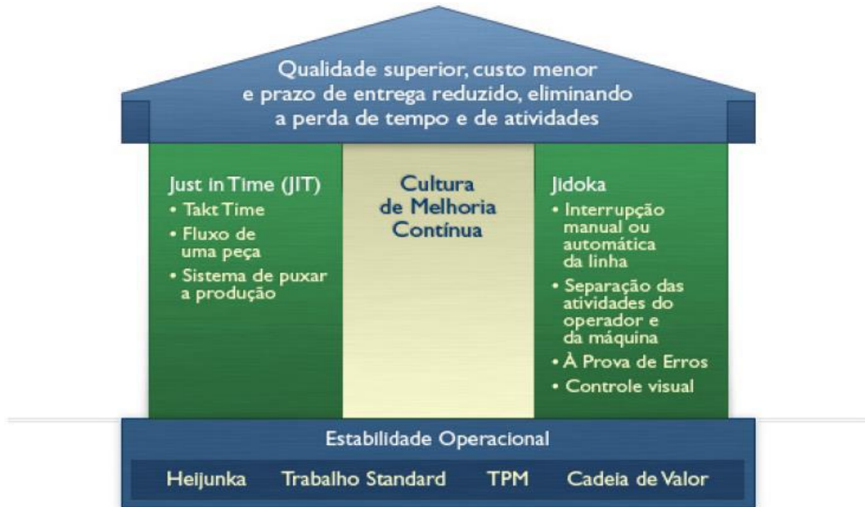
Fig.1: Estrutura do Sistema Toyota de Produção
